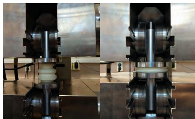
Физические испытания буферов сжатия
