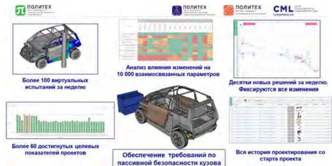
Виртуальные испытания конструкции на пассивную безопасность по требованиям правил ЕЭК ООН и рейтинговым тестам
