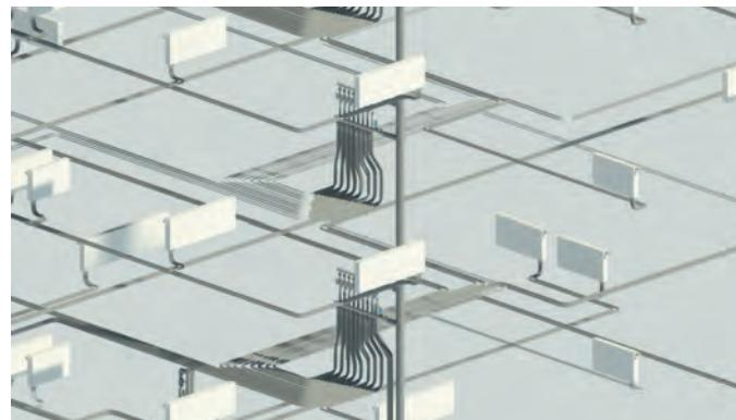
Узлы BIM-модели: отопление
