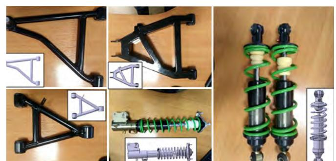
Изготовление деталей и узлов конструкции электромобиля
