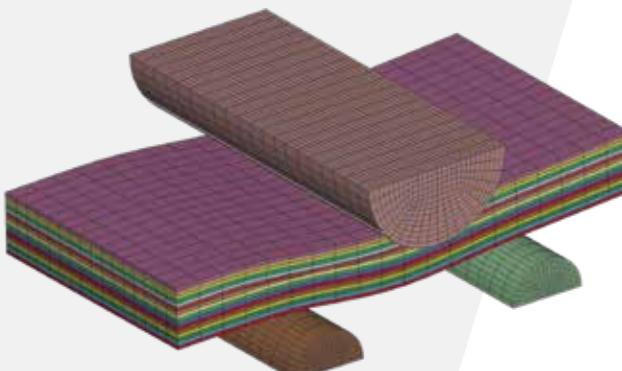
Разработанные ВИС позволяют реализовать и исследовать межслойное разрушение для гибридных ПКМ с учетом различных укладок для технологии намотки, а также служат основой для разработки цифрового двойника изделия.
