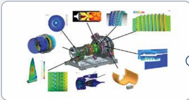
ОДК завершила второй этап разработки технологии цифрового двойника морского ГТД
