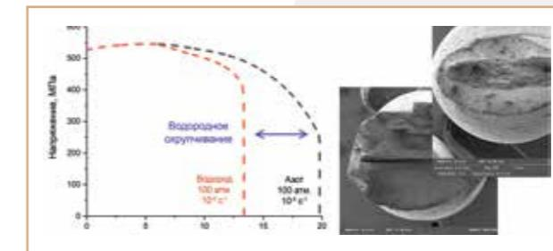
Диаграмма растяжения и внешний вид поверхности разрушения образцов, иллюстрирующие водородное охрупчивание
