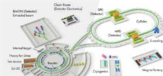
ОИЯИ готовит к запуску адронный коллайдер NICA на базе существующего ускорителя «Нуклotron». На коллайдере предусмотрены две точки пересечения пучков. В первой из них будет размещена установка MPD (MultiPurpose Detector) для изучения барионной материи в экстремальных условиях. Вторая точка предназначена для установки SPD, основной задачей которой станет всестороннее изучение спиновой структуры протона и дейтрана, а также других спин-зависимых явлений.
