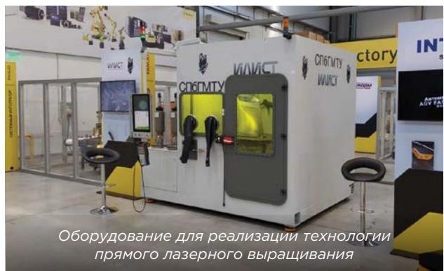
Оборудование для реализации технологии прямого лазерного выращивания
