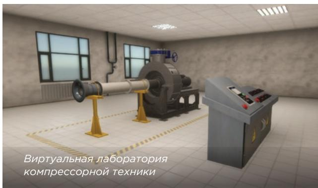
трех типов: центробежного, поршневого и винтового. На первом этапе работ в цифровом виде воссоздана детализированная 3D-модель оборудования с интерактивными элементами управления; на втором этапе – математическая модель для расчета режимов работы оборудования и генерации измеряемых значений; на третьем этапе проведена адаптация модели к работе в режиме VR. В качестве основы для реализации проекта использована платформа разработки в реальном времени Unity.
