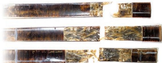
Физико-механические испытания образцов ПКМ
