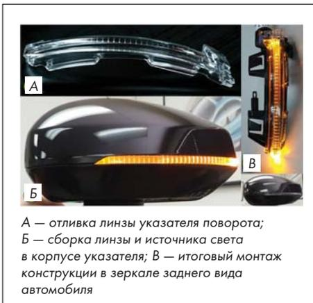
А — отливка линзы указателя поворота; Б — сборка линзы и источника света в корпусе указателя; В — итоговый монтаж конструкции в зеркале заднего вида автомобиля
