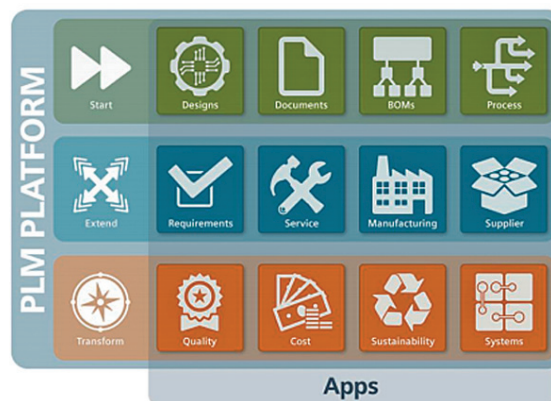
Рис. 2. Ключевая идея архитектуры Siemens Teamcenter – отделение платформы от приложений
