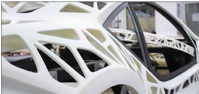
Рис. 5. Концепт кузова EDAG Light Cocoon: бионический дизайн + тканевые материалы (источник: EDAG)
