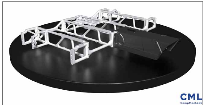
Рис. 9. Конструкция среднего пола
