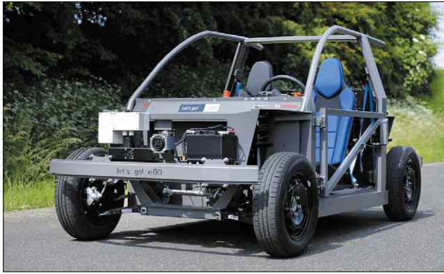
Рис. 4. Прототип платформы e.GO Life немецкой компании e.GO (источник: e.GO)
