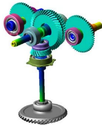
Динамическая модель коробки приводов с упругими корпусами и валами: поля перемещений, возникающих при резком приложении нагрузки
