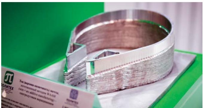
Топ мачты, выполненный из сплава системы Al-Mg-Si методом аддитивного электродугового выращивания с использованием сварочной проволоки (Wire And Arc Additive Manufacturing – WAAM)
