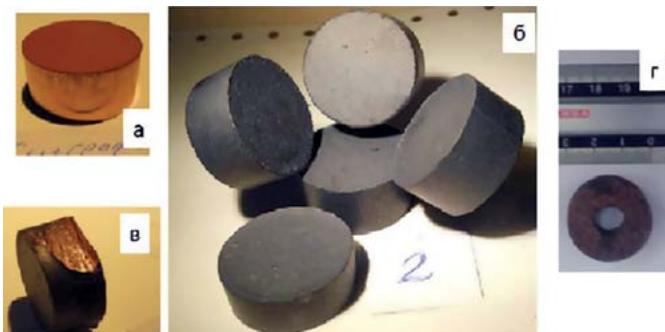
Образцы нанокомпозитов «металл – графен»
