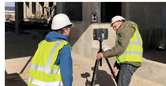
Процесс лазерного сканирования здания инвест-отеля IN2IT
