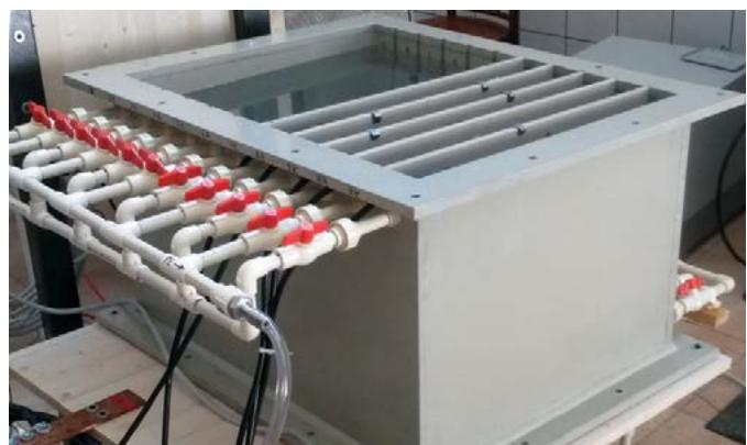
Ферратор, подключены 3 катодных и 2 анодных камеры
