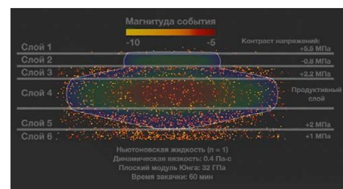
Цифровое моделирование гидроразрыва пласта
