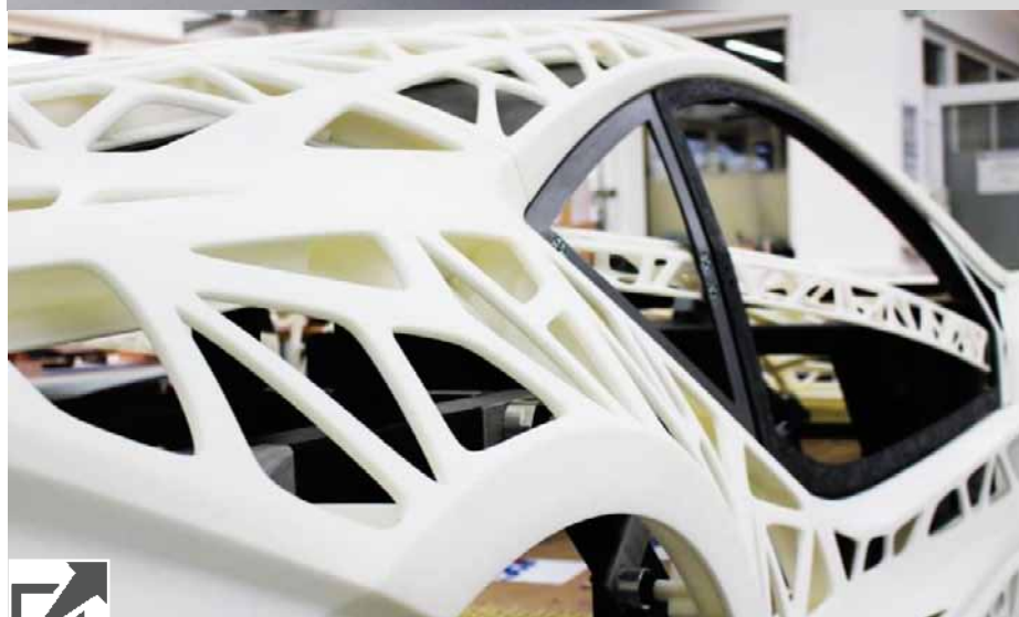
Концепт кузова EDAG Light Cocoon: бионический дизайн + тканевые материалы. Источник: EDAG
